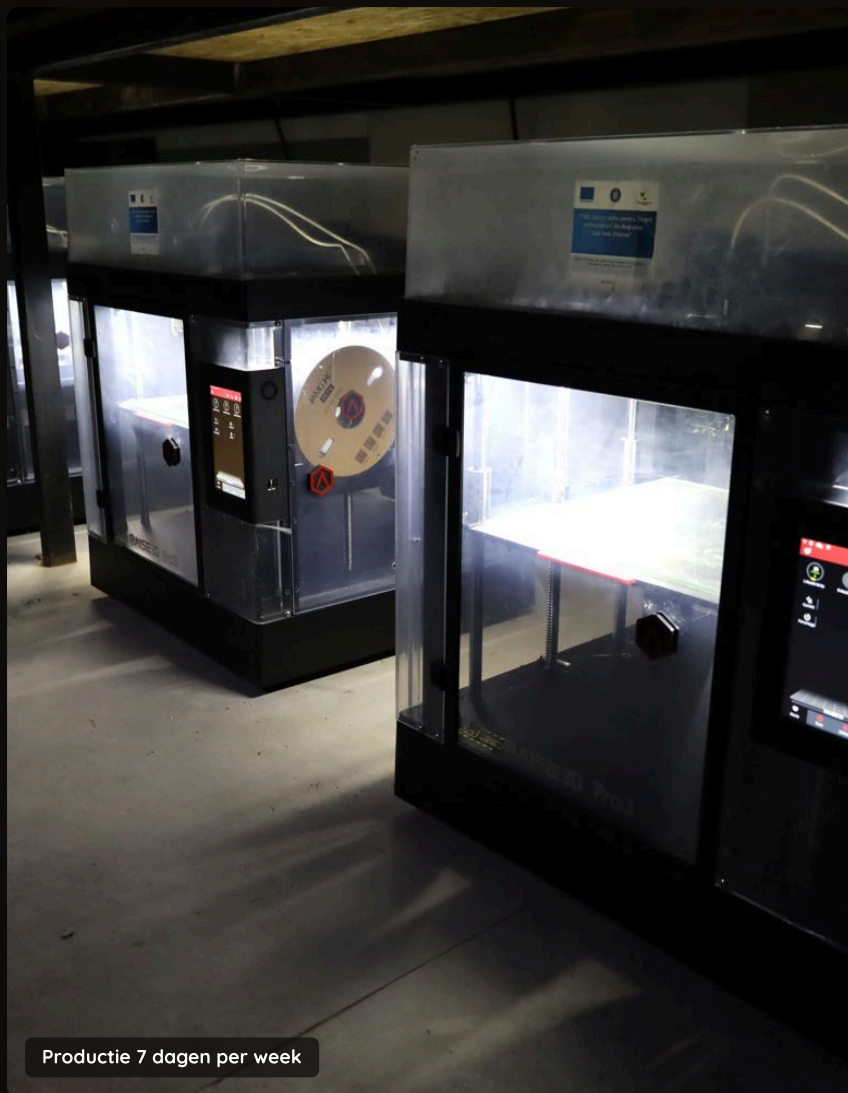
Industriële FDM-printers met gesloten bouwkamer
